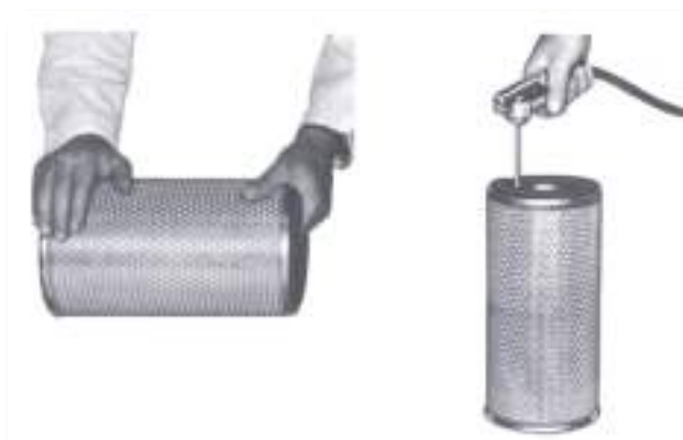
Figura 69 - Limpeza dos filtros
