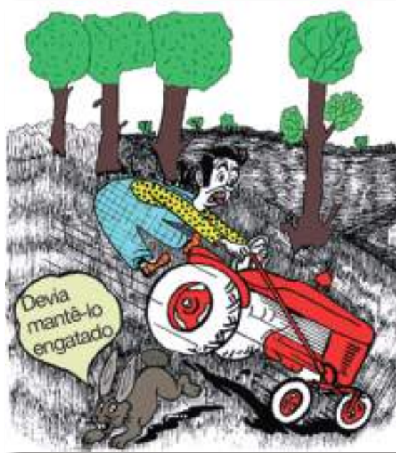
Figura 8 - Não desengatar as mudanças da caixa de velocidades nas descidas
