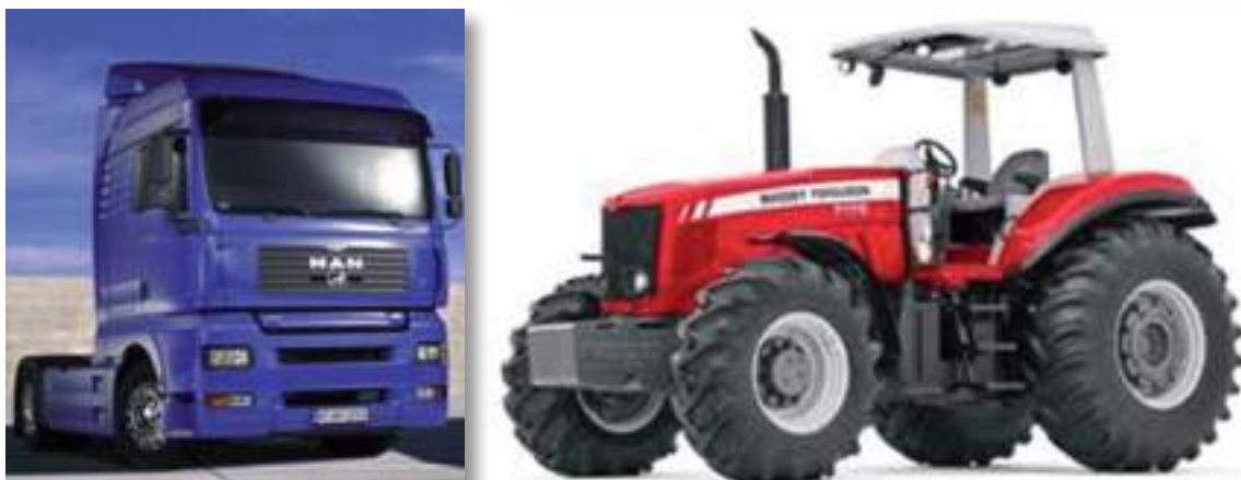
Figura 10 - Trator para transporte rodoviário e Trator agrícola
