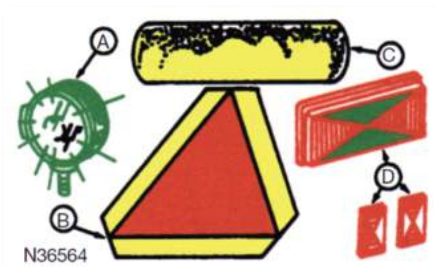
Figura 3 - A - Luzes; B - Sinal de veículo de deslocação lenta; C - Fita refletora; D - Refletores
