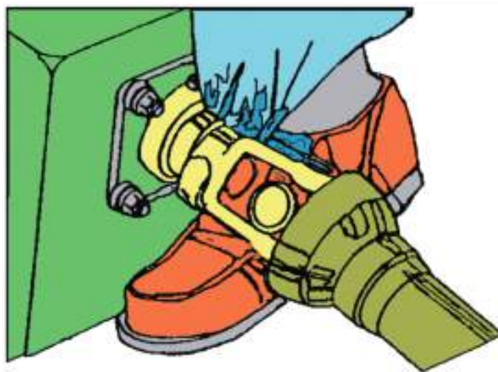
Figura 15 - Cardan sem proteção dá acidente mais grave
